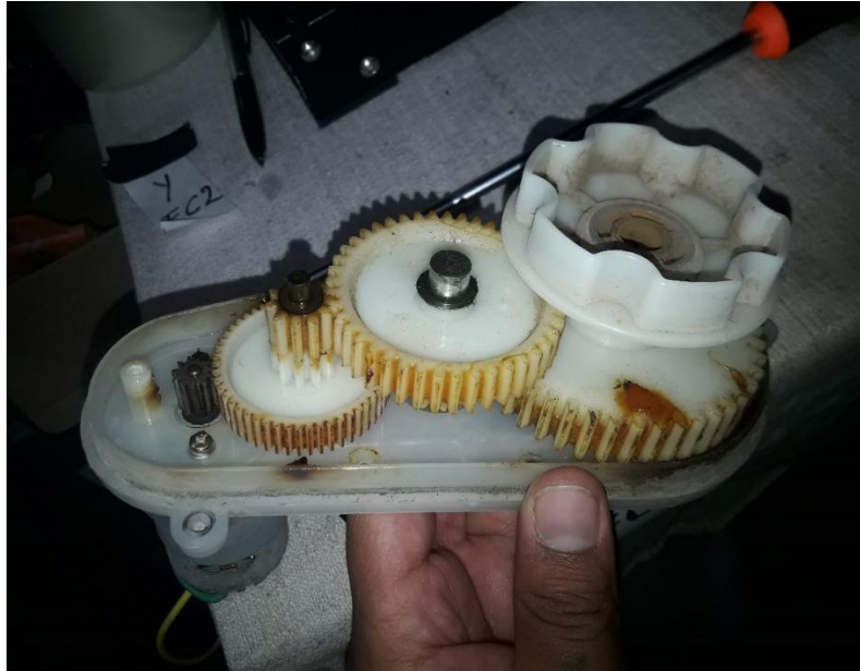
Figura 61: Mantenimiento de los servomotores. Fuente: Autor
